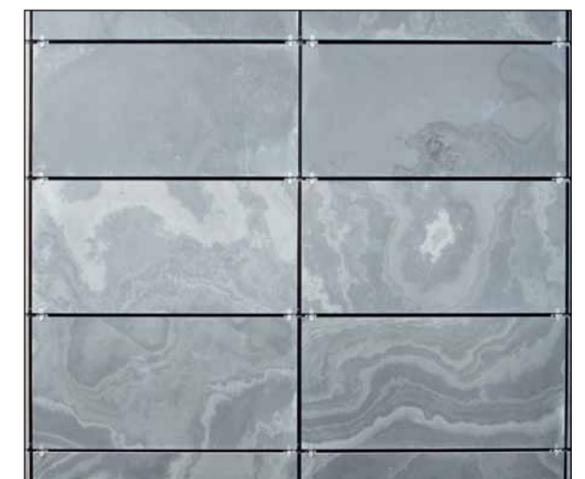
*Pose symétrique horizontale 600 x 300 mm, sur support alu, fixation à l'aide de crochets inox HE130 visibles*
