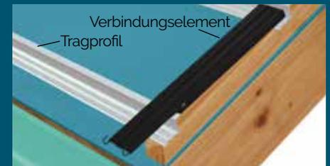
Als Ausgangssituation für das Rathscheck Schiefer-System dient die auf den Sparren befestigte Unterspannbahn mit einer herkömmlichen Konterlattung. Die Tragprofile des Rathscheck Schiefer-Systems werden auf der Konterlattung befestigt. Der Abstand zwischen den Tragprofilen beträgt 31 cm und wird durch die Verbinder vorgegeben.
